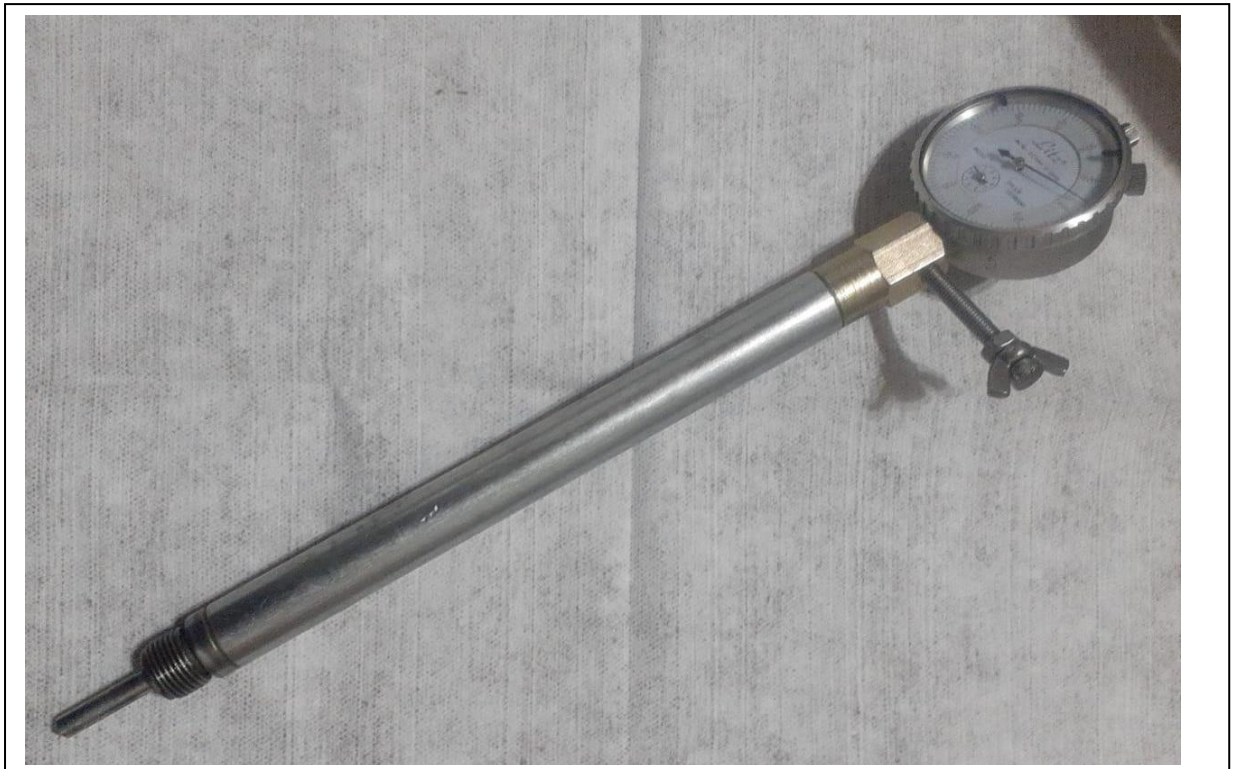
FERRAMENTA FM MOTOR TEST A024 MODIFICADA COM O RELOGIO
